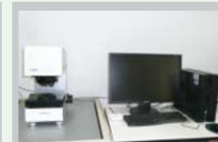
レーザー顕微鏡 横方向の分解能が高い計測を行う時に利用できる共焦点光学系を利用した表面形状計測装置
