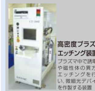
高密度プラズマエッチング装置 プラズマ中で誘電体や磁性体の異方性エッチングを行ない、微細光デバイスを作製する装置
