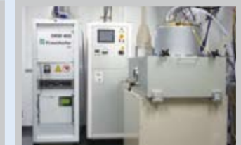
多元スリット装置 世界最先端の矩形波パルスデュアルスリット光源を搭載した光学膜用コーター
