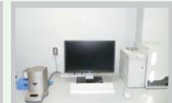
走査型プローブ顕微鏡 デバイスの表面形状評価等、表面のナノ領域で、凹凸、化学的特性、電気的特性を計測する装置
