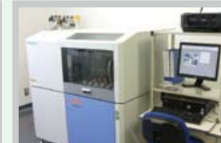
波長分散型蛍光X線元素分析装置 精密な組成分析を行う装置
