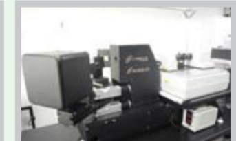
赤外域・多入射角分光エリプソメータ 近赤外から赤外(波長2-30μm)までの光学定数を測定できる装置
