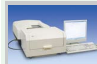
紫外可視赤外分光光度計 紫外から近赤外(波長0.25-2.0μm)までの光学定数が測定する装置
