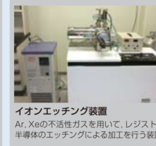
イオンエッチング装置 Ar, Xeの不活性ガスを用いて、レジストや半導体のエッチングによる加工を行う装置
