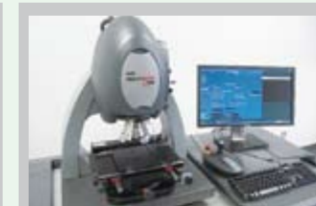
干渉計測装置 デバイスの表面形状など、奥行き方向の分解能が高い計測を行う表面形状計測装置
