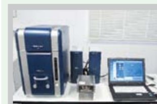
卓上電子顕微鏡 数十ナノメートル程度のサイズの計測を行う小型の電子顕微鏡。組成分析も可能
