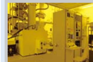
電子ビーム描画装置 10nm以下の微細パターンを描画することが可能なナノ構造加工装置
