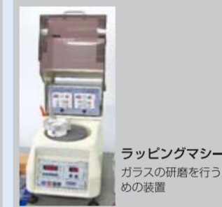
ラッピングマシン ガラスの研磨を行うための装置
