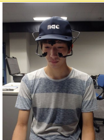
アイマークレコーダを使用した視線追跡でデザイン検証
