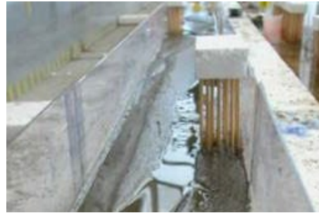
河川に繁茂した植生が流れや地形変化に与える影響を室内実験で検討
